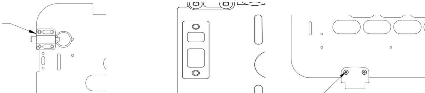
7. Befestigen Sie die Grundplatte (1) mit dem Edelstahlstift (2) am Scharnierblatt (3).
