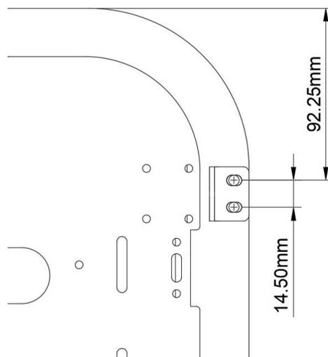
2. Montieren Sie die Verschlusshalterungen mit den entsprechenden Schrauben auf den Fensterrahmen.
