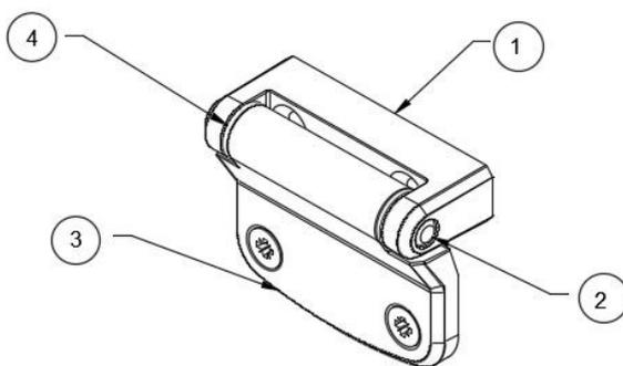
6. Montieren Sie die Scharnierblätter (2x), die Rastbolzen (2x) und die Schutzplatten (2x) mit den zugehörigen Schrauben am Overlander.
